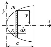
Povucimo na ploči dve prave, paralelne  $y$  i i od nje na rastojanju  $x$  i  $x + dx$ .
