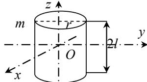
Kružni cilindar poluprečnika  $r$ , mase  $m$ , visine  $2l$  ima aksijalni moment inercije mase za težišne ose  $x, y, z$  oblika  $J_x = J_y = \frac{m}{12}(3r^2 + 4l^2)$ , i  $J_z = \frac{mr^2}{2}$
