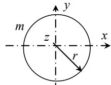
Tanki kružni disk poluprečnika  $r$ , mase  $m$  ima aksijalne momente inercije mase za težišne ose  $x, y, z$  oblika  $J_x = J_y = \frac{mr^2}{4}$ , i  $J_z = \frac{mr^2}{2}$
