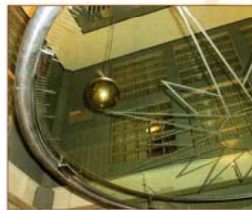
La sphère en laiton d'une masse de 32 kg a un diamètre de 200 mm. Elle est fixée à l'extrémité d'un fil d'acier galvanisé (3 mm de diamètre), d'une longueur de 16 m.
