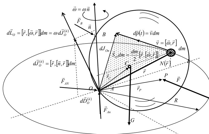
Za telo koje se obrće oko nepokretnе ose ugaonom brzinom  $\omega$  i ugaonim ubrzanjem  $\dot{\omega}$ , I koje ima u tački  $O$  sferno ležište, a u tački  $B$  cilindrično ležište, izveli smo na osnovu teorema o promeni impulsa kretanja i promeni momenta impulsa kretanja sledeće dve vektorske jednačine:
